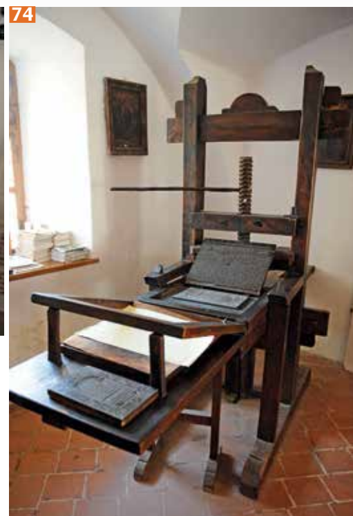
73 Preotul profesor Vasile Olteanu, sufletul Muzeului Prima Școală Românească, explicând vizitatorilor cum funcționa tiparul. 74 Placa de lemn incizată sau cea culeasă cu litere mobile era unsă cu cerneală și apoi imprimată pe hârtie, prin presare în teasc cu șurub de lemn. 75 Catedra școlară din secolul al XIX-lea. Scrisul se învăța pe tăblițe de ardezie.
